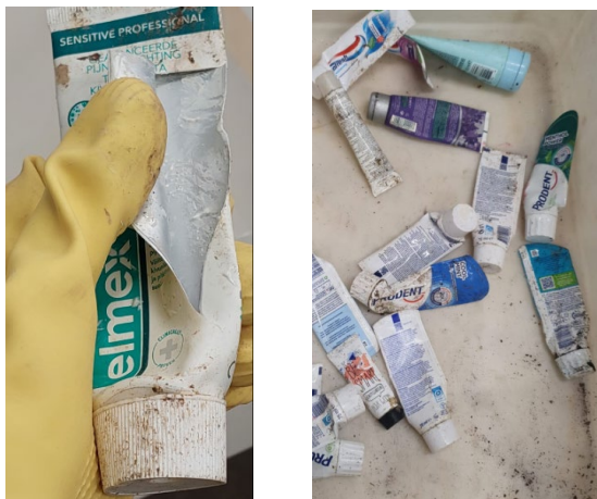
Figuur 15 Voorbeeld van een tandpasta tube met een aluminium binnenlaag (links) en zonder aluminium binnenlaag (rechts). De tubes rechts zijn goed recyclebaar.
