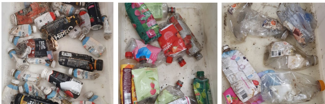
Figuur 6 Foto's van beperkt recyclebare PET flessen. Links: PET flessen ≤0.5L die beperkt recyclebaar zijn door het label. Midden: PET flessen >0.5L die beperkt recyclebaar zijn door het label. Rechts: PET flessen >0.5L die beperkt recyclebaar zijn door materiaalverontreinigingen.
