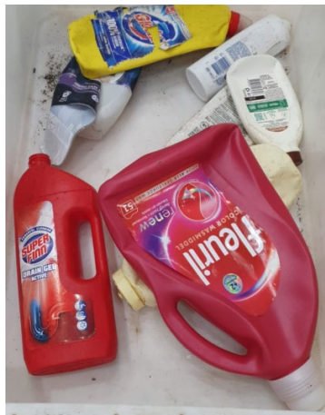
Figuur 8 PP (links), PE (midden) en PET (rechts) flacons die beperkt recyclebaar zijn door stoorstoffen.
