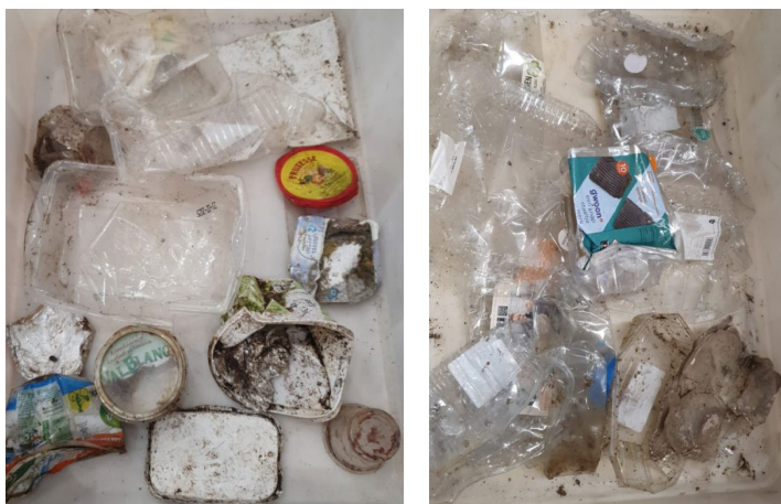
Figuur 9 PP (links) en PET (rechts) dieptrek en vormvaste verpakkingen die stoorstoffen bevatten.
