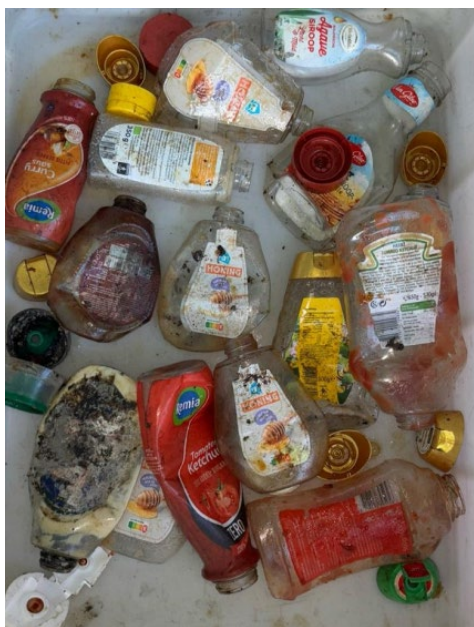
Figuur 14 Voorbeelden van verpakkingen met spuitmondjes die blijven drijven en dus niet van siliconen zijn gemaakt.
