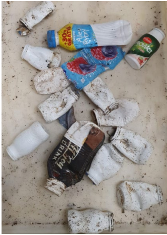
Figuur 7 PE flessen die beperkt recyclebaar zijn.
