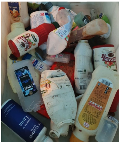
Figuur 8 PP (links), PE (midden) en PET (rechts) flacons die beperkt recyclebaar zijn door stoorstoffen.
